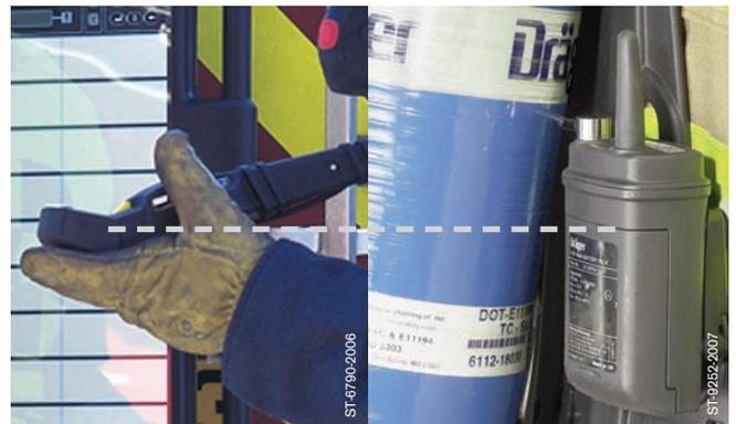
El eslabón IR del módulo portátil de datos transmite datos del Sentinel® al tablero de control, situado fuera del incidente.
